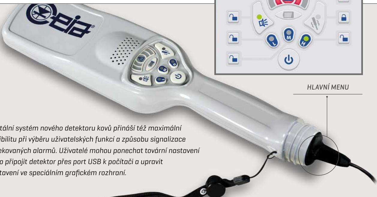
Digitální systém nového detektoru kovů přináší též maximální flexibilitu při výběru uživatelských funkcí a způsobu signalizace detekovaných alarmů. Uživatelé mohou ponechat tovární nastavení nebo připojit detektor přes port USB k počítači a upravit nastavení ve speciálním grafickém rozhraní.
